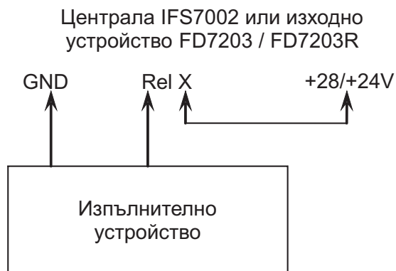
б) схема на свързване на изпълнително устройство към релеен изход
